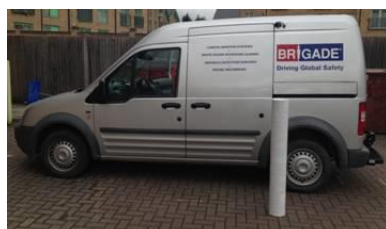
Słupek o wysokości 1 m pod kamerą zamocowaną na wysokości 1,8 m
