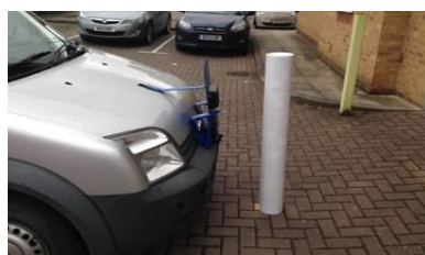
Słupek o wysokości 1 m pod kamerą zamocowaną na wysokości 0,6 m
